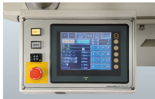
タッチパネル式操作盤、データ設定も豊富
