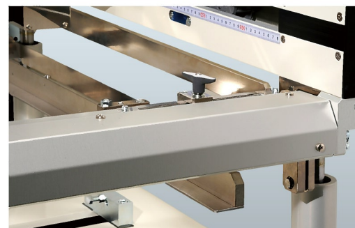
大きな版枠のスライド投入、ワンタッチロック
