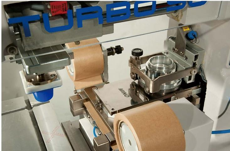
キャリッジドライブ形式のパッド印刷機としてご好評を得ているターボシリーズは、版を前後させその下にオートパッドクリーナーを装着することで、十分なクリーナー面積と大きな印刷面積を確保しています。
