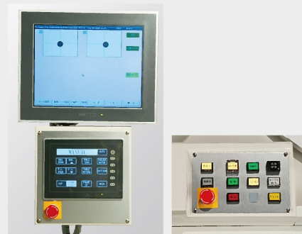
押しボタン式とタッチパネルのハイブリッド操作盤で全自動化も容易
