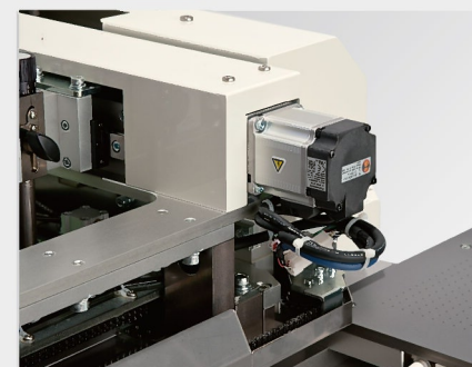
駆動系はサーボモーターにより完全な数値化、データ管理。
