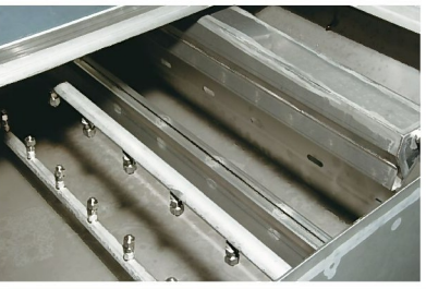
溶剤を水に置換 (洗浄) し、エアブローで吹き飛ばす。
