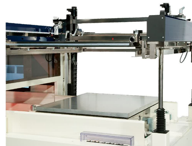
プリンティングヘッドのリフトアップ(最大435mm) 安全装置付き
